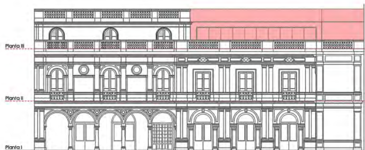
Ampliación propuesta. Fachada Principal y Fachada Trasera.
