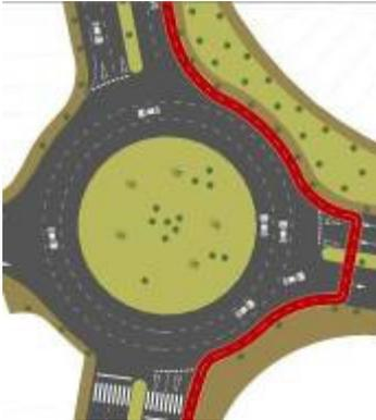
Tal y como se muestra en el esquema, la glorieta que regula el tráfico entre las Avenidas del Alcalde Jesus Mantaras, Chiribitos, del Pollo y la Calle Bruselas se soluciona con la integración del carril bici en calzada previendo la puesta de medidas de seguridad para el ciclista como barandillas de acero galvanizado que refuercen la prioridad del ciclista dentro de las glorietas.
