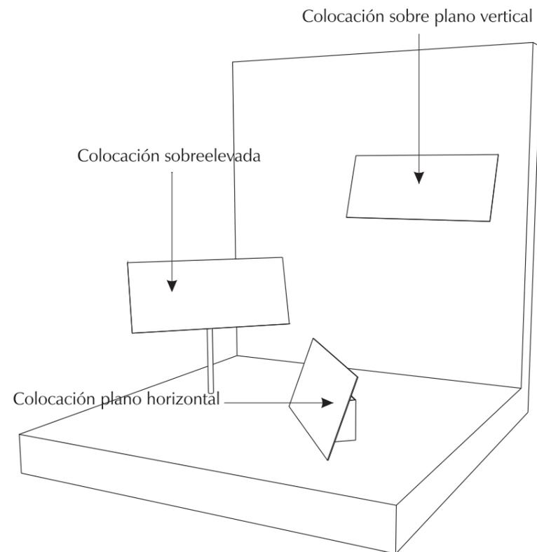
**Nota:** Soporte de información compuesto por base fabricada con chapa de acero inoxidable plegada, tubo de acero inoxidable de 20 mm de diámetro y chapa de acero inoxidable con información gráfica serigrafiada.
