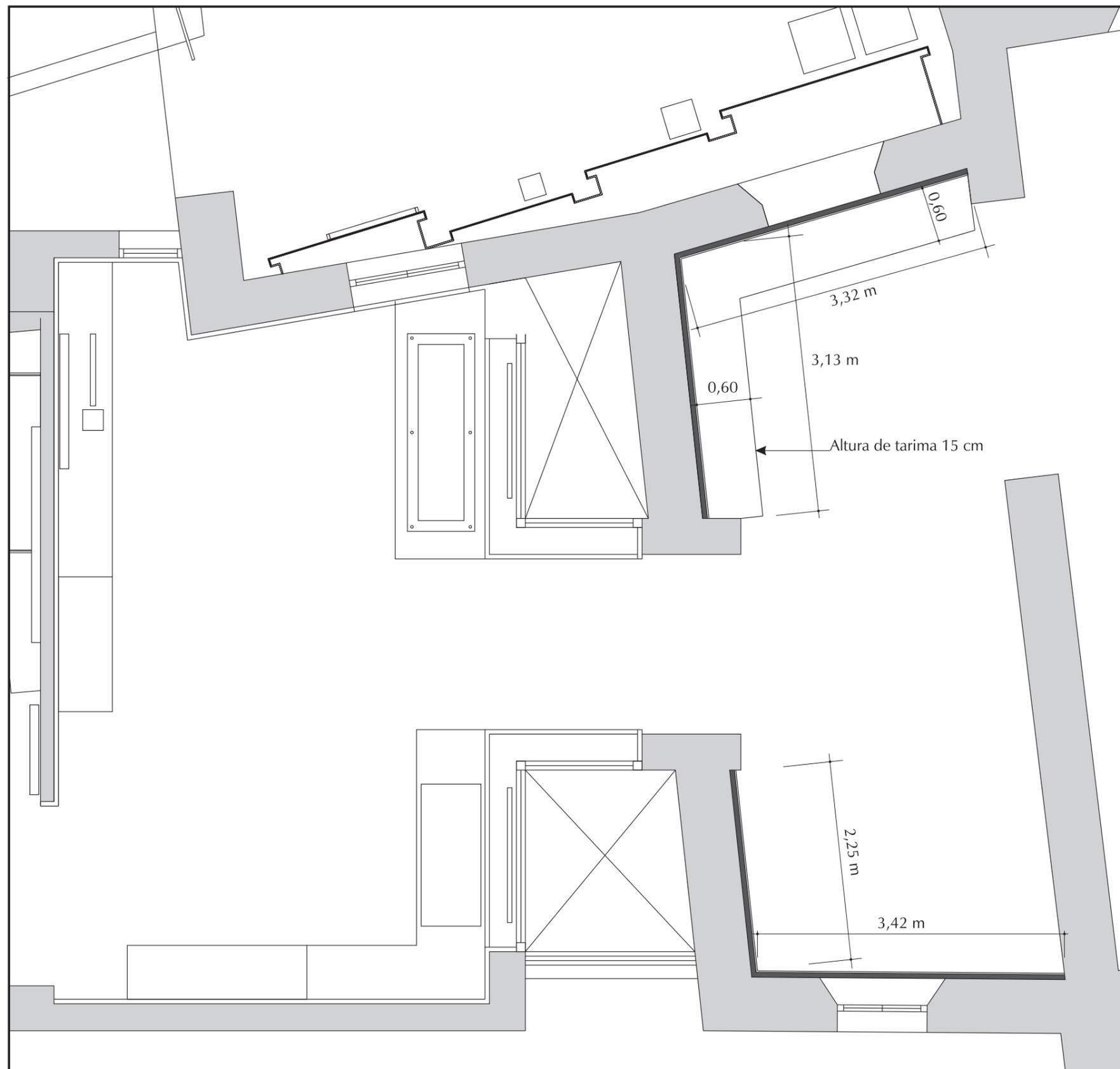
**Nota:** Forro perimetral y tarima expositiva fabricadas con tablero de DM de 16 mm de espesor lacado en negro, con estructura interior de listones de madera en el caso del forro perimetral y costillas de tablero de DM de 19 mm de espesor en el caso de la tarimas expositiva.
