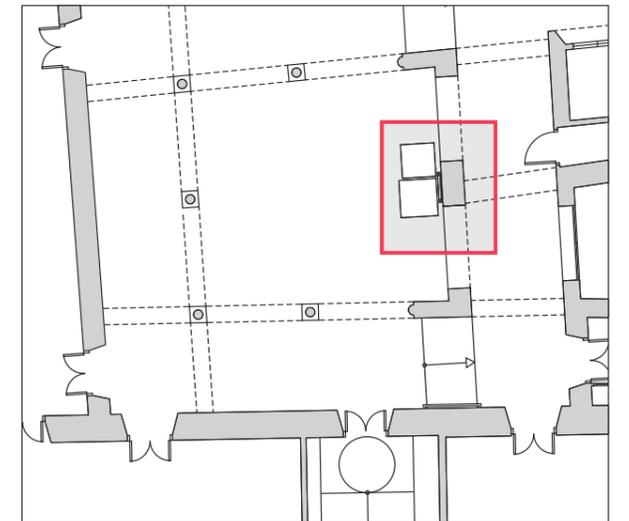
**Nota:** Pódiums para capitel consistente en bloque de hormigón fabricado in situ, recubierto con placas de granito abujardado. Silueta metálica fabricada con tubo rectangular de acero inoxidable de sección 60 x 20 mm fijado a la pared.
