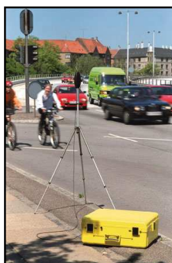
Fig. 29. Equipo de exteriores Tipo 3592 Bruel & Kjaer
